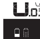
Lors de la recharge des deux batteries d'un vélo à deux batteries, l'écran indique l'état d'avancement de la charge des deux batteries (sur la figure ci-contre, la batterie de gauche est en train d'être chargée). La batterie en train d'être chargée est reconnaissable au fait qu'elle clignote.
