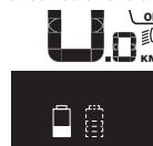
**U.0** Se in una eBike con due batterie inserite verranno caricate entrambe le batterie, sul display verrà visualizzato l'avanzamento della carica per entrambe le batterie (nella figura, la batteria in fase di carica è quella sinistra). L'indicazione lampeggiante sulla batteria indicherà quale delle due batterie si trovi al momento in fase di carica.
