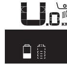
Se numa eBike com duas baterias colocadas forem carregadas ambas as baterias na bicicleta, então no mostrador é exibido o progresso de carregamento de ambas as baterias (na imagem está a ser carregada de momento a bateria esquerda). Qual das baterias está a ser carregada é reconhecível na indicação a piscar na bateria.
