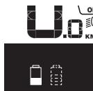
Werden an einem eBike mit zwei eingesetzten Akkus beide Akkus am Fahrrad geladen, so wird auf dem Display der Laufortschritt der beiden Akkus angezeigt (in der Abbildung wird gerade der linke Akku geladen). Welcher der beiden Akkus gerade geladen wird, können Sie an der blinkenden Anzeige am Akku erkennen.
